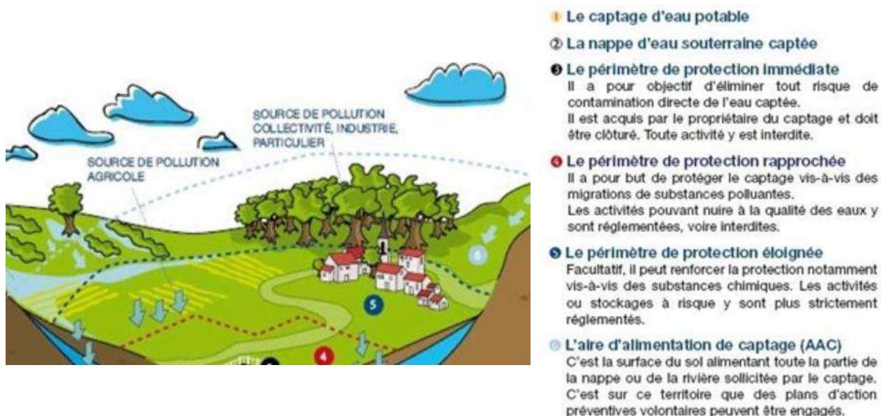
Carte 7. Représentation schématique des dispositifs de protection des captages (Vernoux et Buchet, 2010)
