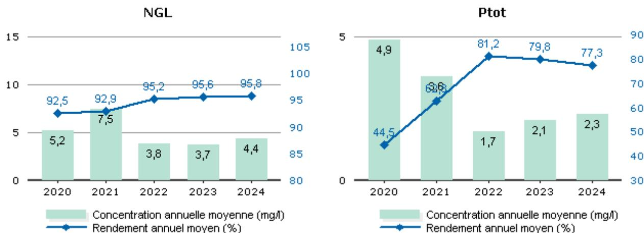
Les valeurs moyennes observées en sortie du système de traitement (concentrations et rendements) ne permettent pas de mesurer le respect de la prescription qui est à présent à calculer en considérant les débits à hauteur du débit de référence. L'évaluation du taux de respect fait l'objet de l'indicateur de conformité locale présenté dans la suite de la présente section.
